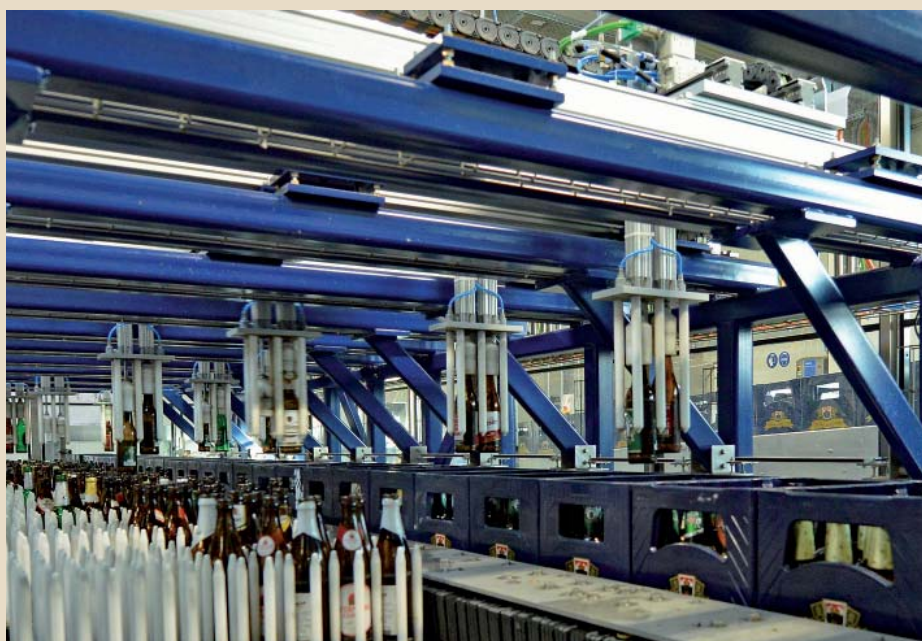
Abb. 5 Automatische Sortierung der Flaschen im Kasten
