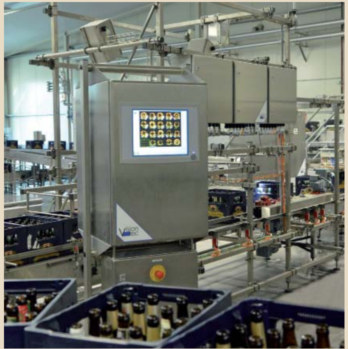
Abb. 3 Die Kastenkontrolle garantiert eine Erkennungsgenauigkeit von über 99,7% Foto: vision-tec
