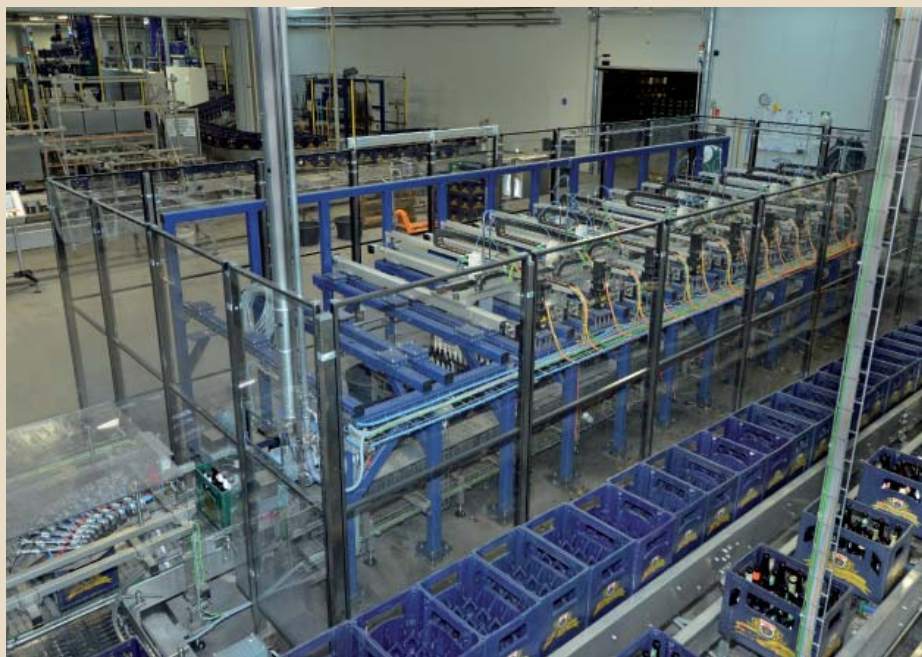
Abb. 4 Der neue Sortierroboter in der Darguner Brauerei
