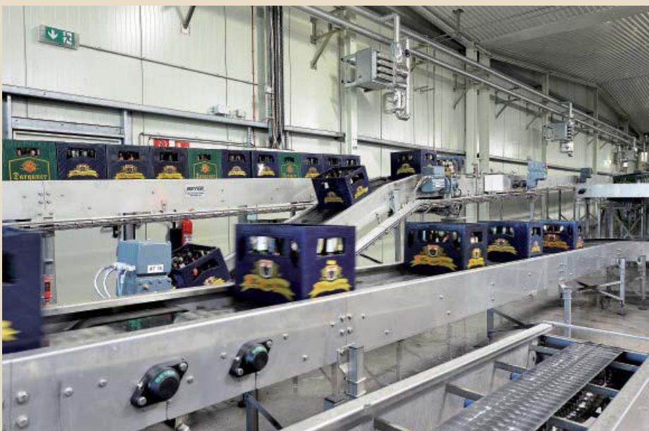
Abb. 2 Die zu sortierenden Kisten werden mittels Weiche auf einer Bahn zusammengeführt Foto: Beyer
