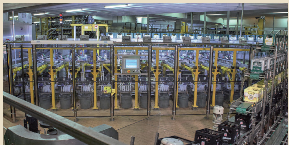
Abb. 7 Sortierroboter mit drei-etagiger Leerkastenzuführung
