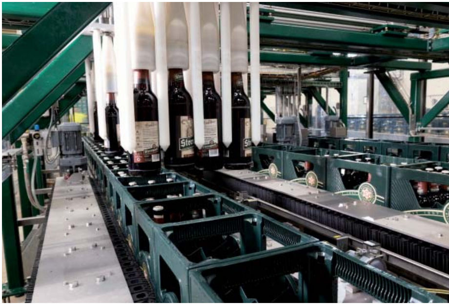
Abb. 3 Der Umpackroboter packt in den „endlosen Kästen“, denn er erfasst nicht jeden Kasten einzeln, sondern packt die Flaschen in einen (angenommenen) endlosen Strom von Gefachen
