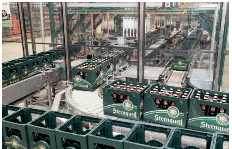
Abb. 2 Der Umpacker besteht aus drei Einzelportalen und drei Kastenbahnen
